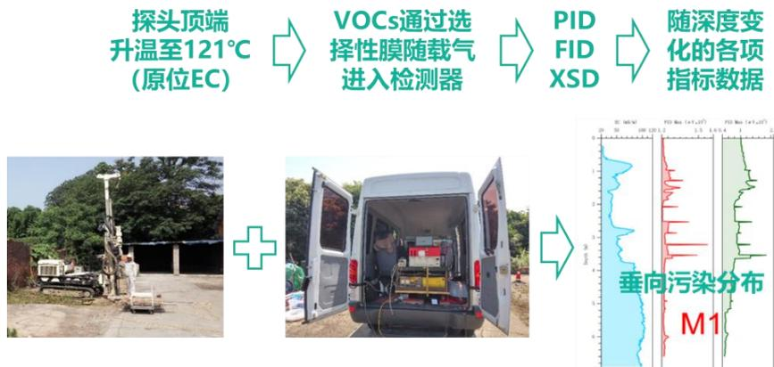
图 9 MIP 原位检测示意图
